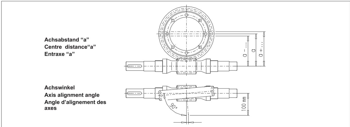
**50.1 Gehäuse-Achsabstands- und Achswinkelabmaße / Housing centre distance and axis alignment angle deviations / Ecartes sur l'entraxe carter et sur l'angle d'alignement**
