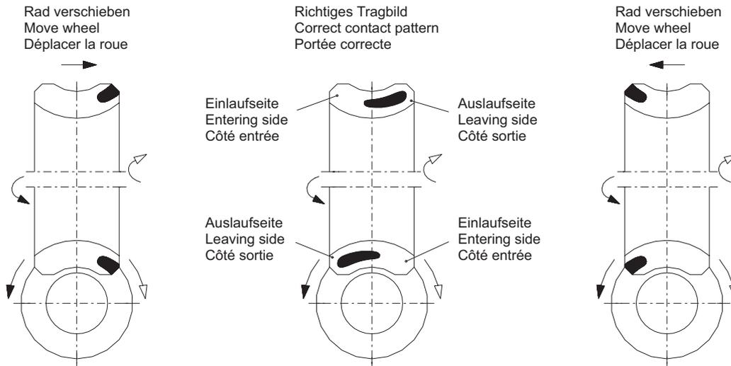
Gleichartige Pfeile kennzeichnen die Abhängigkeit der Drehrichtungen zwischen Schnecke und Schneckenrad.
