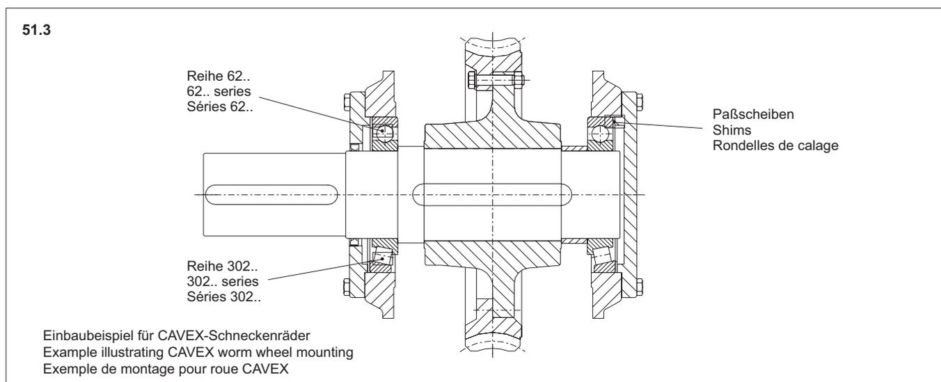
In den Bildern 51.1 bis 51.3 sind mehrere Schnecken- und Schneckenrad-Lagerungen dargestellt. Je nach Anwendungsfall können auch andere Lösungen erwogen werden. Bei Schneckenrad-Lagerungen müssen die Räder zum Einstellen des Tragbildes axial verschiebbar sein.
