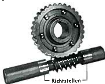
Bild 6.1 Richtstellen an einer Schnecke mit vorgedrehten Schäften
