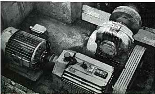
Stufenlos einstellbares HYVARI-Getriebe Bauart HMOO Größe 50 und CAVEX-Getriebe Bauart CUHW Größe 200 im Antrieb von Doppel-Paddelschnecken für Schlammkohlenförderung
